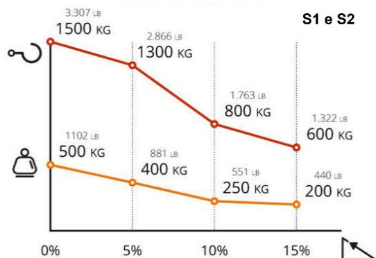
Dati di traino in pendenza indicativi e variabili secondo il tipo di superficie, numero e stato ruote unità di carico da trainare.
